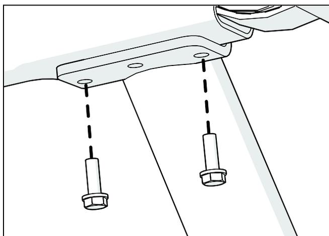
**Рис. 2: Установка крепежного винта на боковую опору**
