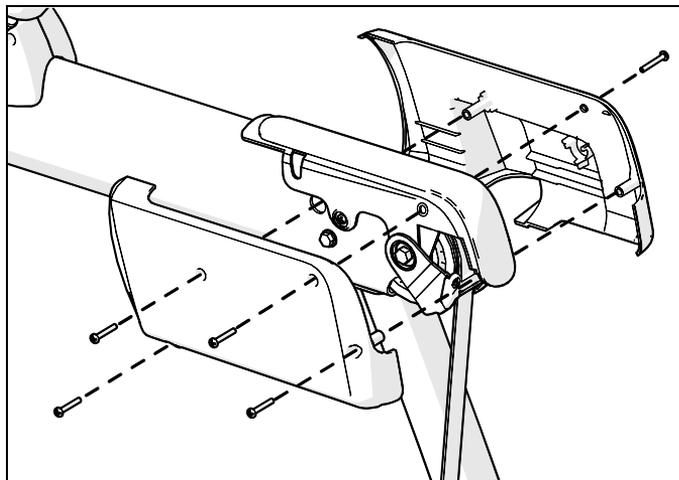
**Рис. 8: Установка крышек боковых опор**
