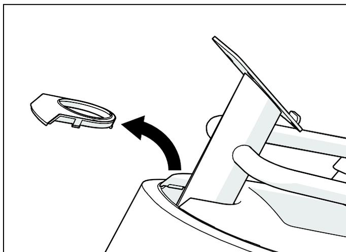
Рис. 10: Удаление влагоизоляции
