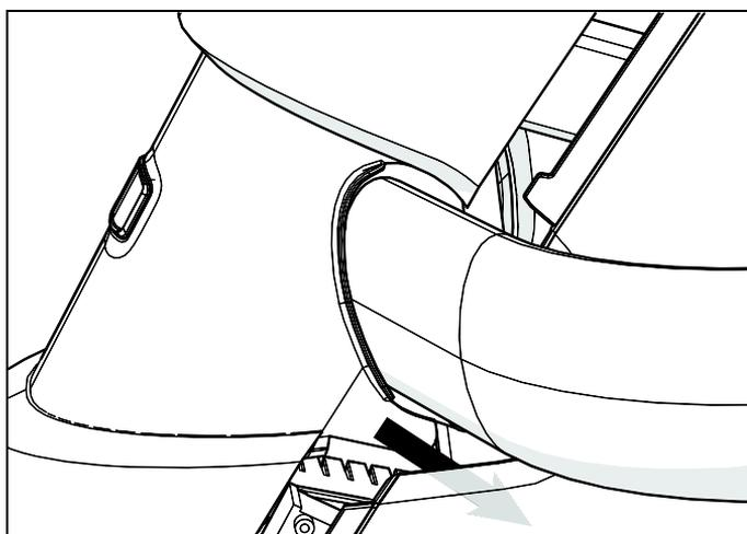
**Рис. 18: Установка передней крышки**
