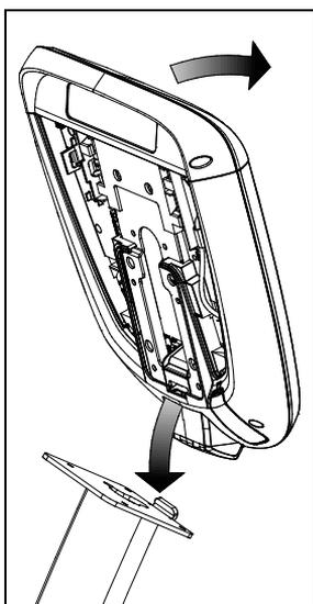
**Рис. 32: Размещение консоли на базе**
