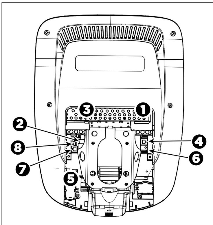
Рис. 27: Кабельные соединения, консоль P80
