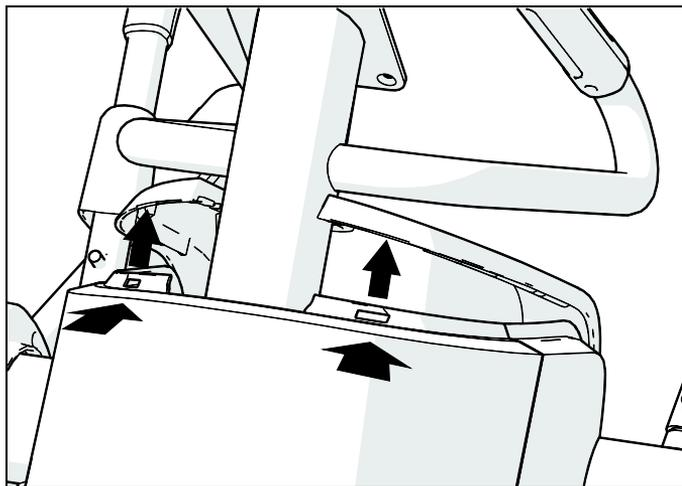
**Рис. 11: Снятие верхней крышки**
