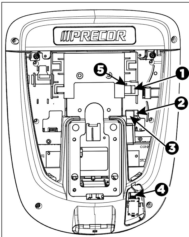
Рис. 34: Кабельные соединения, консоли P30 и P10
