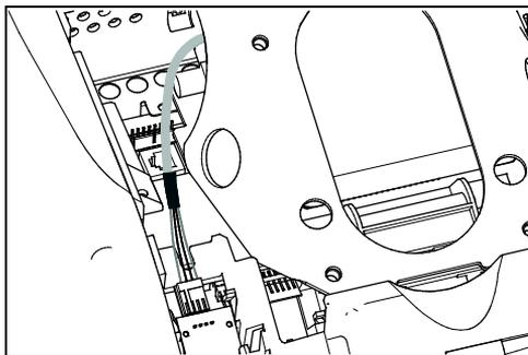
**Рис. 30: Подключение кабеля датчика частоты сердцебиения**
