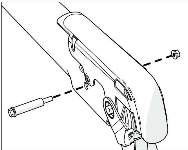
**Рис. 4: Крепление винта и муфты для установки боковой опоры**
