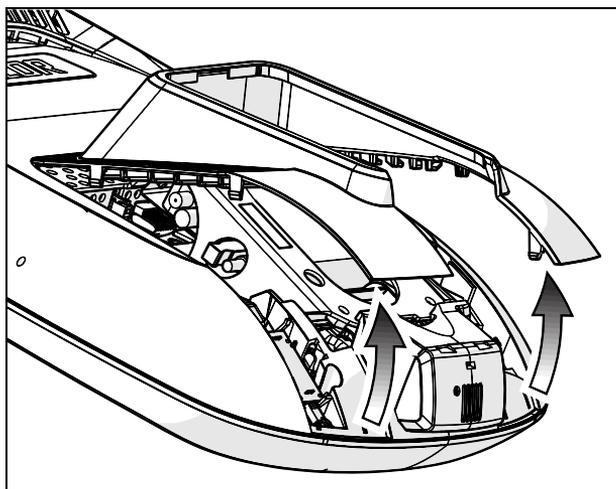
Рис. 25: Снятие кожуха доступа с консоли P80
