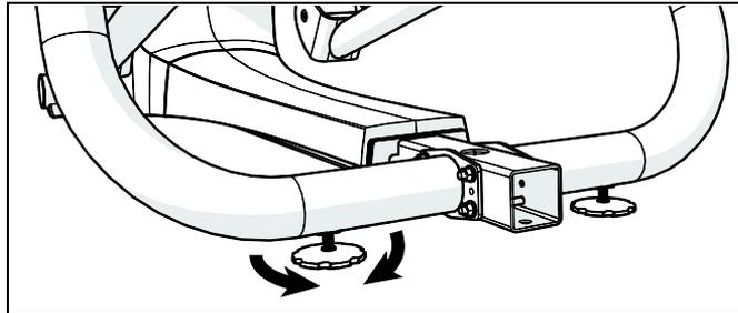
**Рис. 23: Расположение регулируемых опор**
