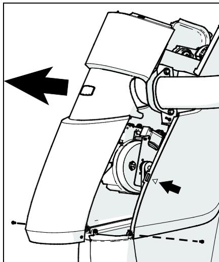
**Рис. 13: Снятие передней части корпуса**
