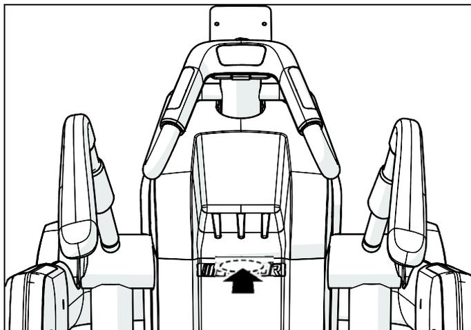
**Рис. 12: Удаление задней части верхней крышки**
