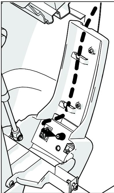
**Рис. 14: Прокладка кабеля в кабельном канале**
