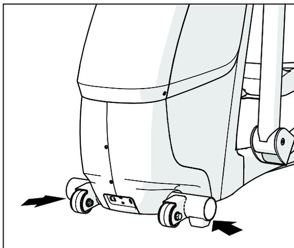
**Рис. 9: Положения передних фиксаторов корпуса**
