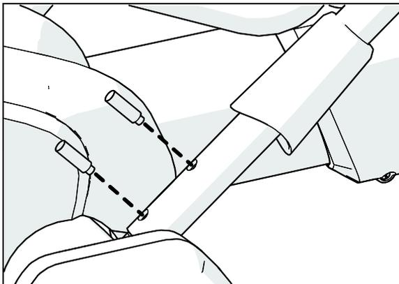
**Рис. 20: Удаление стопорных винтов на рукоятке**
