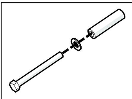
**Рис. 3: Установка муфты и шайбы**
