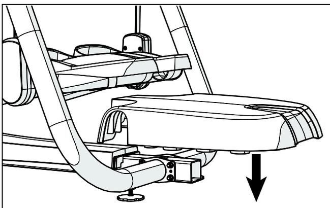
**Рис. 24: Установка заднего основания**
