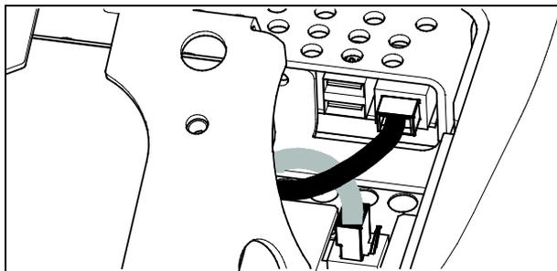
**Рис. 29: Подключение кабелей передачи данных Ethernet и основания аппарата**
