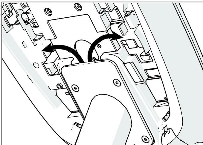
**Рис. 33: Прокладка кабеля из корпуса в консоль**
