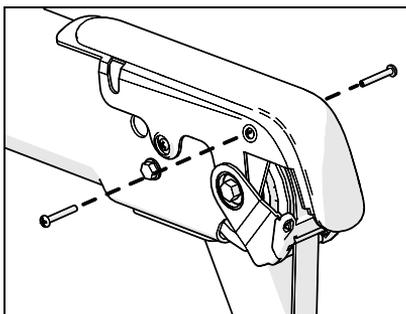
**Рис. 7: Удаление винтов из внутренней пластиковой формы**
