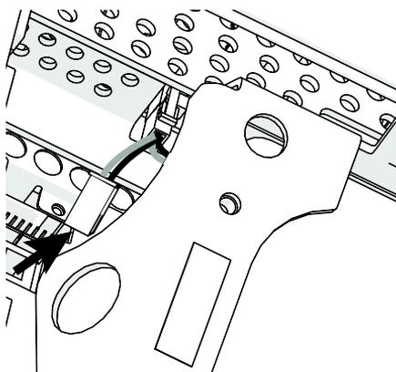
**Рис. 31: Подключите кабель электропитания**
