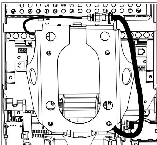
**Рис. 28: Подключение телевизионного кабеля**
