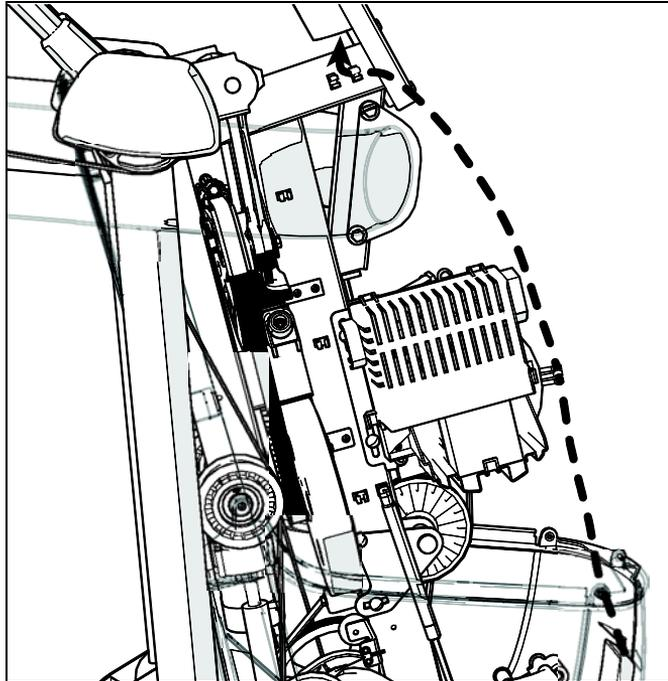
**Рис. 16: Прокладка кабеля вдоль рамы к центральной колонне**
