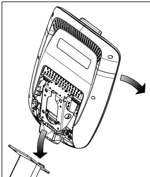
**Рис. 26: Размещение консоли на базе**
