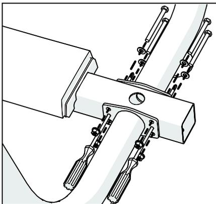
**Рис. 6: Установка нижних боковых опор**
