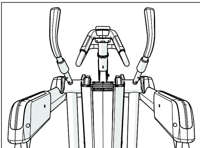
**Рис. 22: Установка рукояток**
