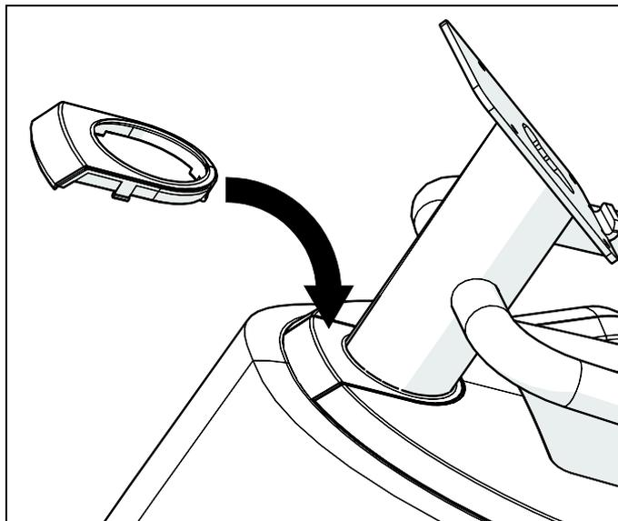
**Рис. 19: Установка влагоизоляции**
